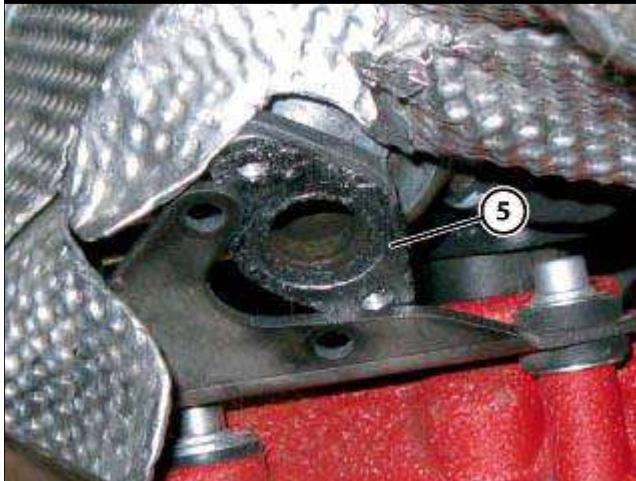
● 拆卸二次空气管并取出排气歧管和阀上相应密封件 (5)。
