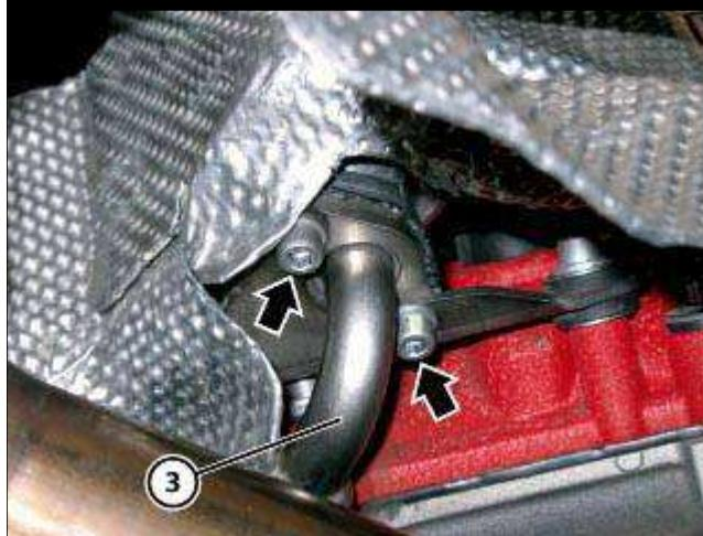
● 松开指示的将二次空气管 (3) 紧固至相应阀的螺钉。
